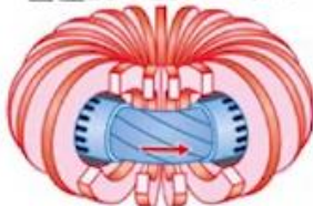
磁場方式核融合炉 2つの磁場のねじり方 直径10~20メートル
