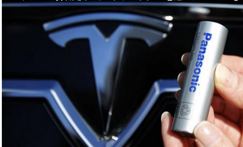
モデル3で採用されたパナソニックの電池セル「2170」
